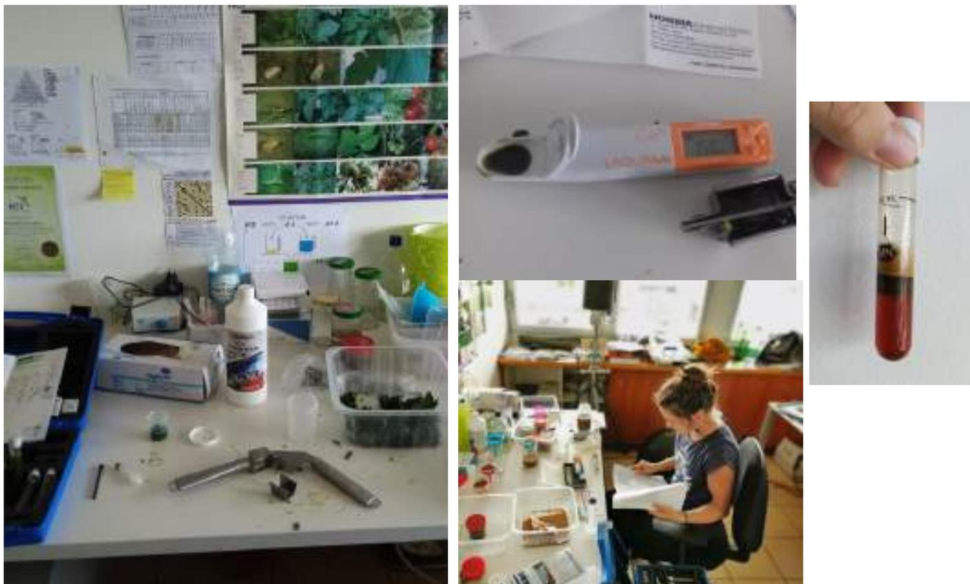
Photomètre PF<sub>3</sub> et inomètre Laquatwin. Analyses de jus de feuilles et de terre au bureau de REPAIR.
