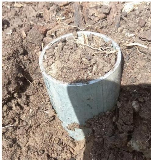
*Méthode du cylindre pour la mesure de la densité apparente*
