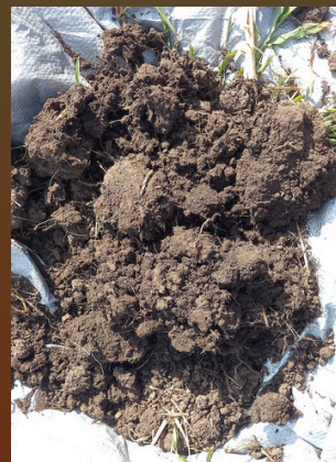
Bloc après drop test : terre fine + petites mottes friables + grosses mottes moins ouvertes
