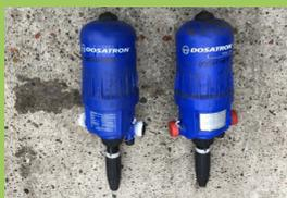
Pompe doseuse pour injection du biostimulant dans le système d'irrigation
